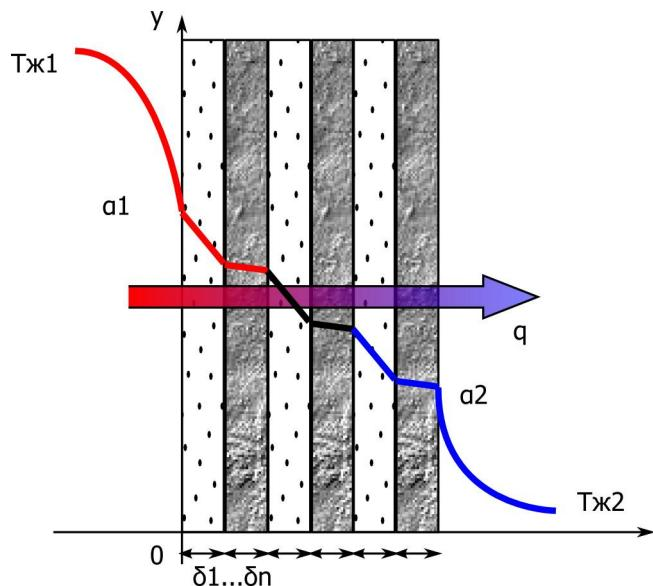
При стационарном режиме теплообмена плотности теплового потока от первого теплоносителя к стенке, через стенку и от стенки ко второму теплоносителю одинаковы. С учетом формул для многослойной плоской стенки плотности теплового потока определяются выражениями:
