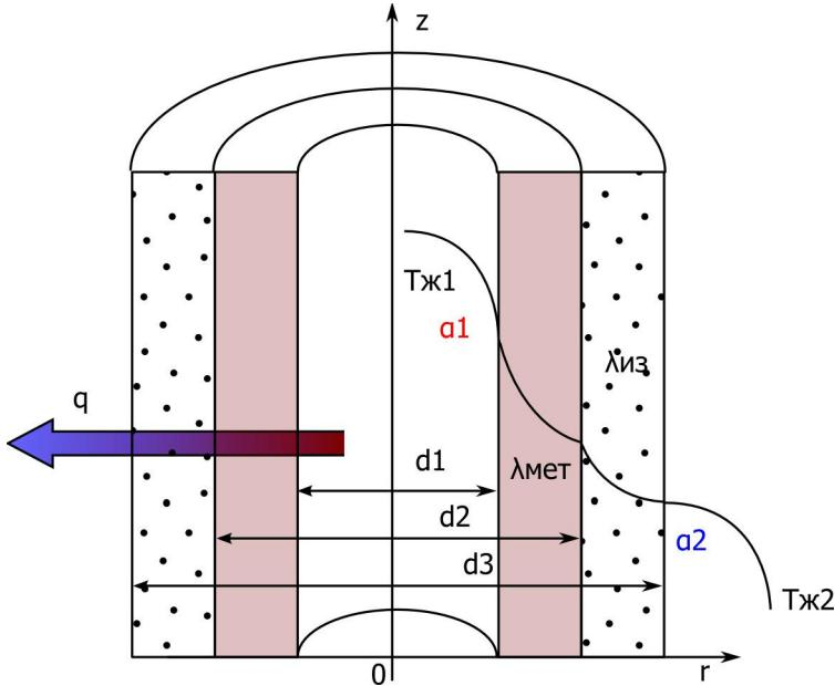
В общем виде зависимость теплопотерь от диаметра внешней изоляции и её теплопроводности можно записать следующим образом:
