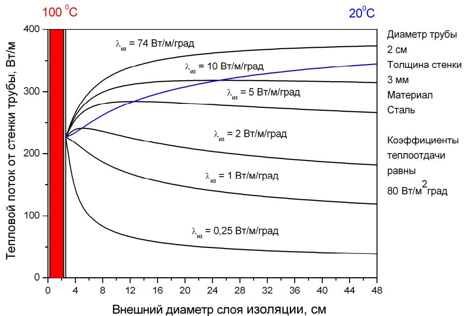
На рисунке линиями сверху вниз представлены расчёты теплопотерь жидкости при изоляции трубы различными материалами от стекловаты до стали.
